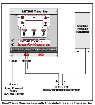
The MST2000 with Ab so lute Pres sure Trans mit ter can be wired to re place your ex ist ing four wire trans mit ter. Re quires two 24Vdc power sources.
